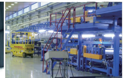
工业幕墙复合板自动化生产线
