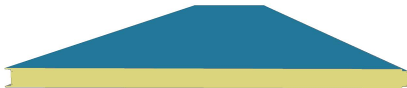
金属面聚氨酯冷库板板型图
